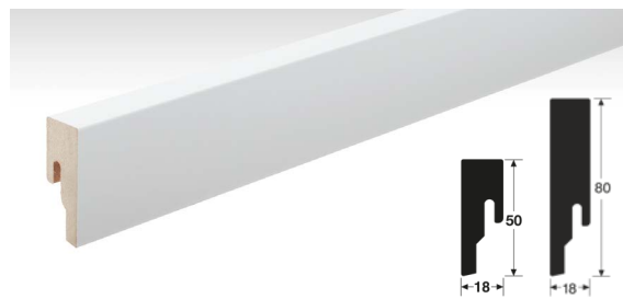
Design-Sockelleiste DSL 50 | 80 (weiß) 18 x 50 x 2380 mm 18 x 80 x 2380 mm
